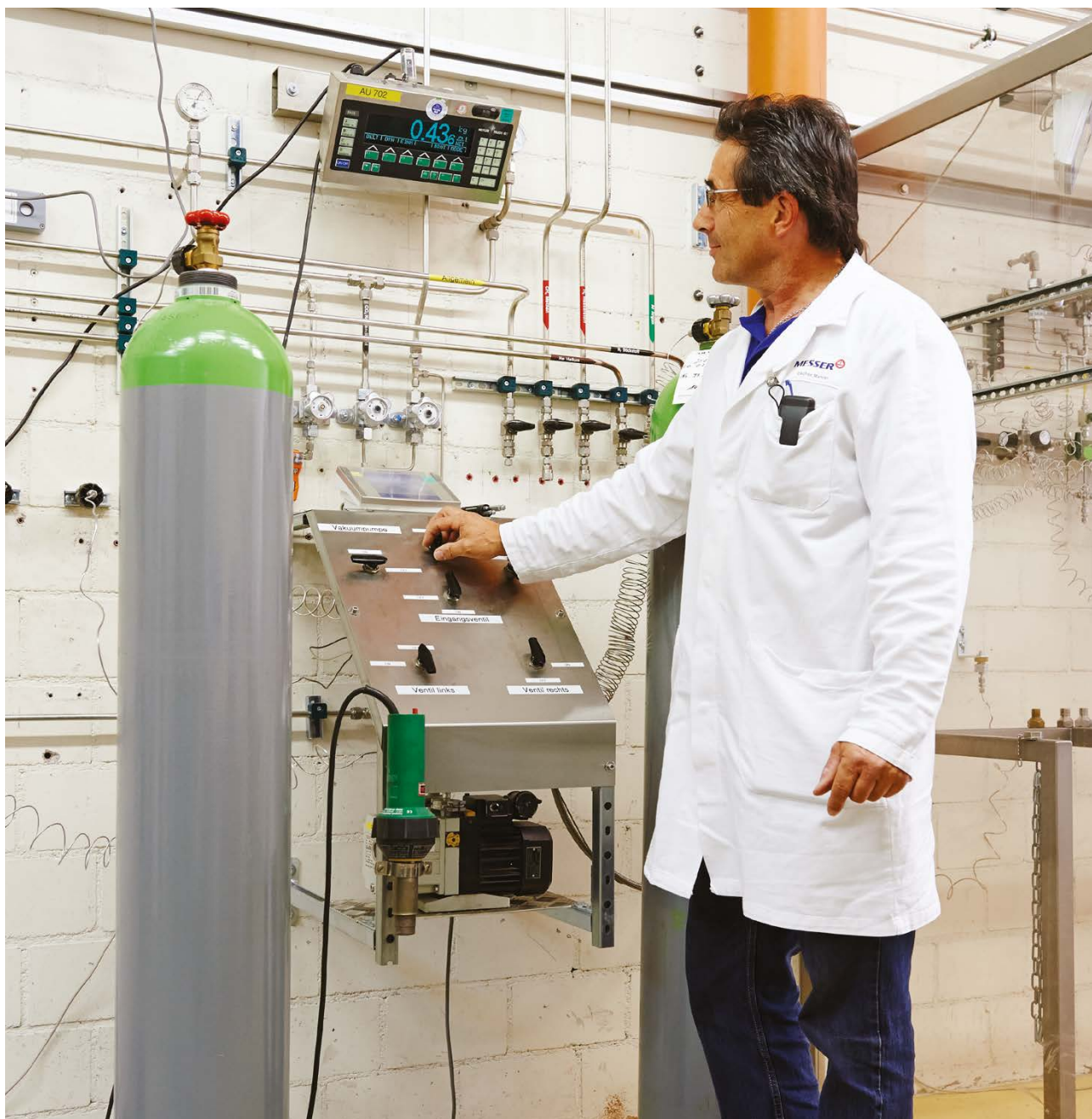
Gázkeverékek előállítása gravimetrikus módszerrel
